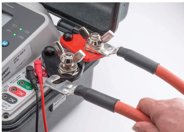
Byl vyvinut nový adaptér svorek, aby se umožnilo používání vlastních měřicích vedení uživatele.
