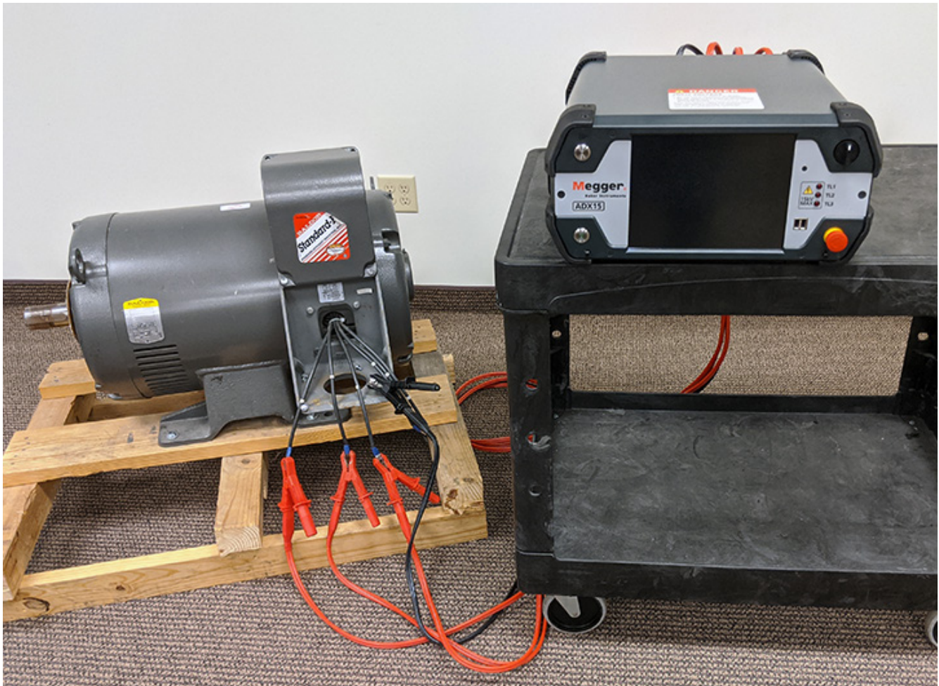
Obr. 27: Zajištění správného oddělení a umístění měřících vodičů ADX a kabelů zařízení.
