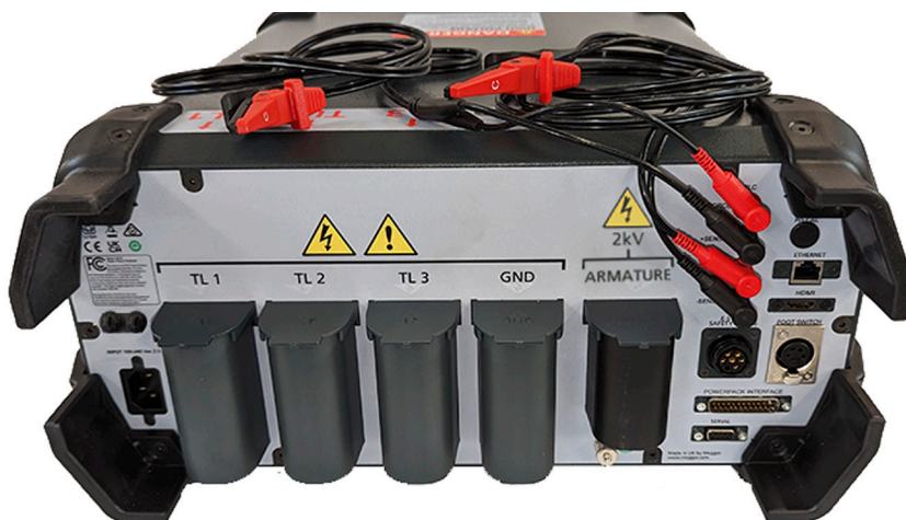
Obr. 130: RLC konektory se sadou klipů.
