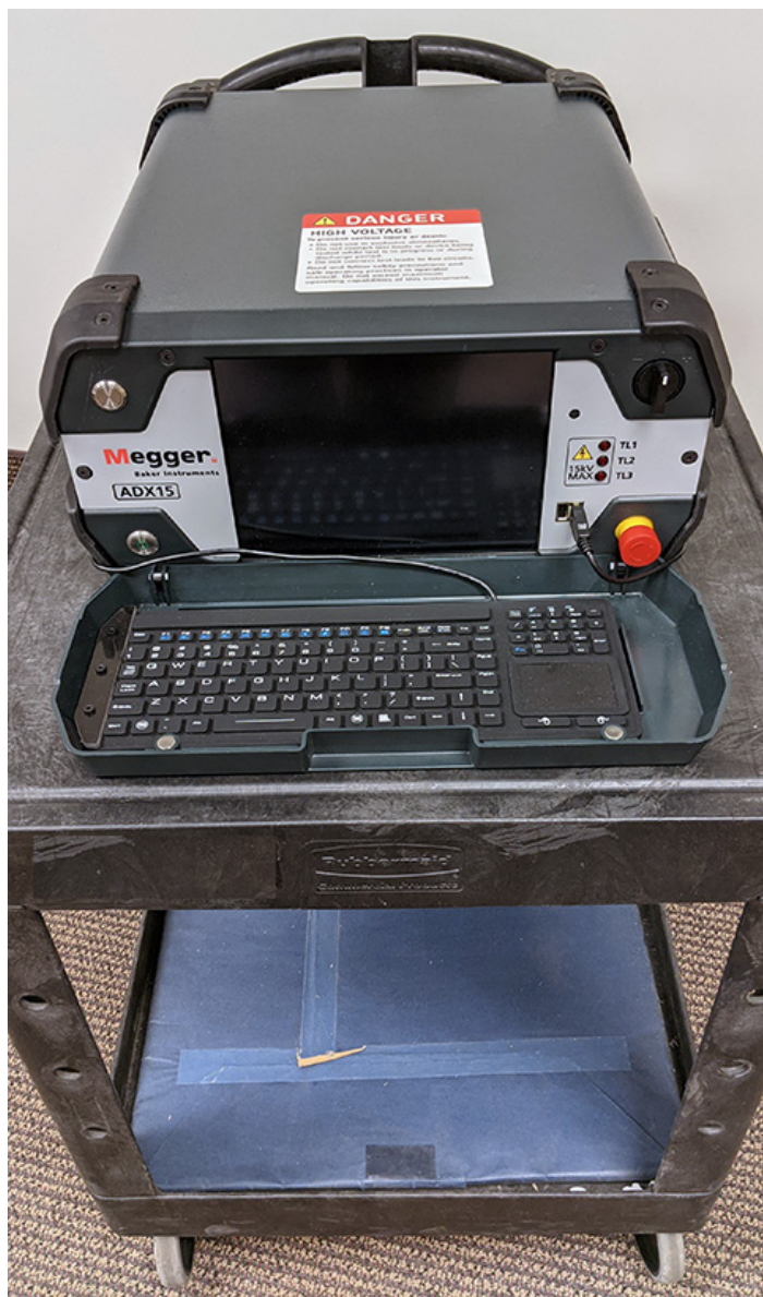
Obr. 19: Zařízení ADX na pracovním vozíku. Všechny spodní ochranné rohy se plně dotýkají, kolečka jsou zablokována.
