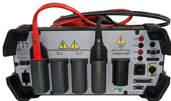
Obr. 3: Před každým použitím zkontrolujte zásuvky pro měřicí vodiče a kabely.
