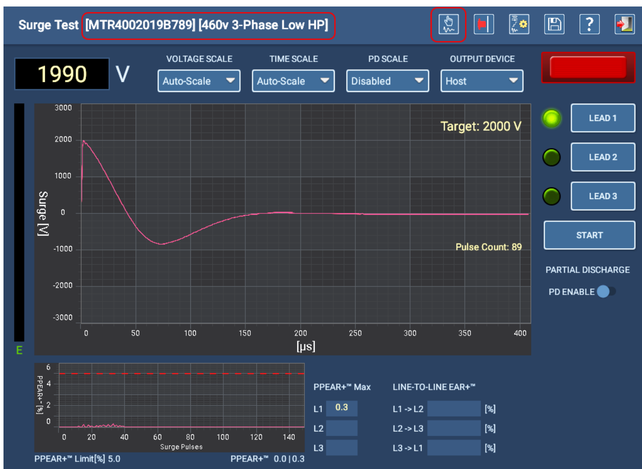
Obr. 88: Získání referenčního průběhu pro rázovou zkoušku na vodiči LEAD 1.
