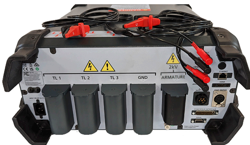
Obr. 101: Testování armatury RLZ používá konektory RLC a ruční sondy nebo spony – zobrazena sada klipů.
