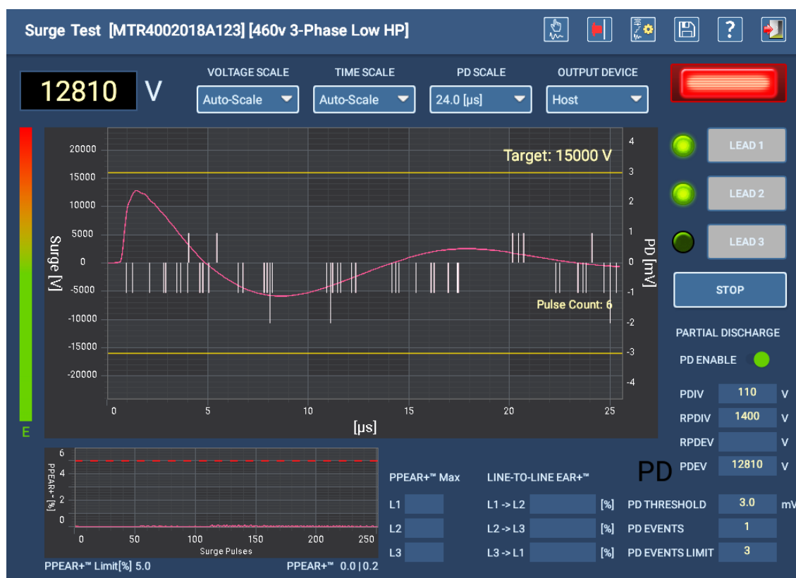
Obr. 118: Sloupec rázové energie indikující maximální dosaženou energii.
