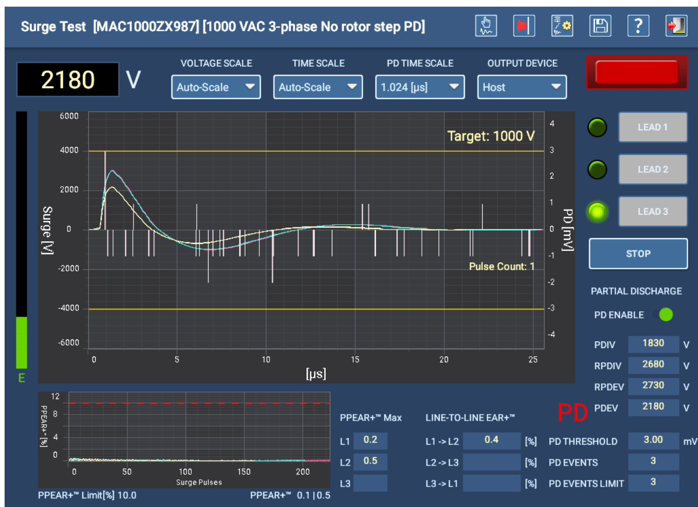
Obr. 113: Napětí klesá na cílovou hodnotu (zde 1000 V) a zachycuje hodnoty zániku pro vodič 3.
