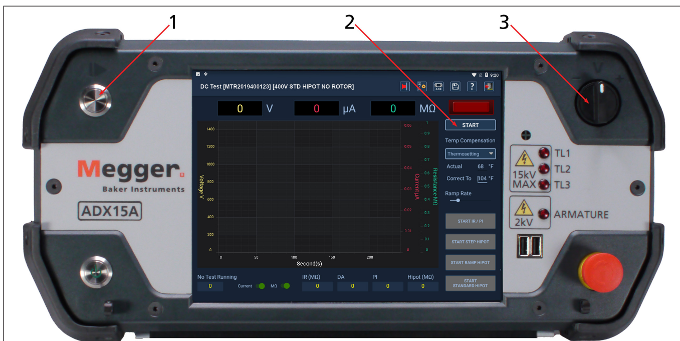
Obr. 84: Ovládací prvky předního panelu a uživatelského rozhraní ADX pro spuštění DC testu.
