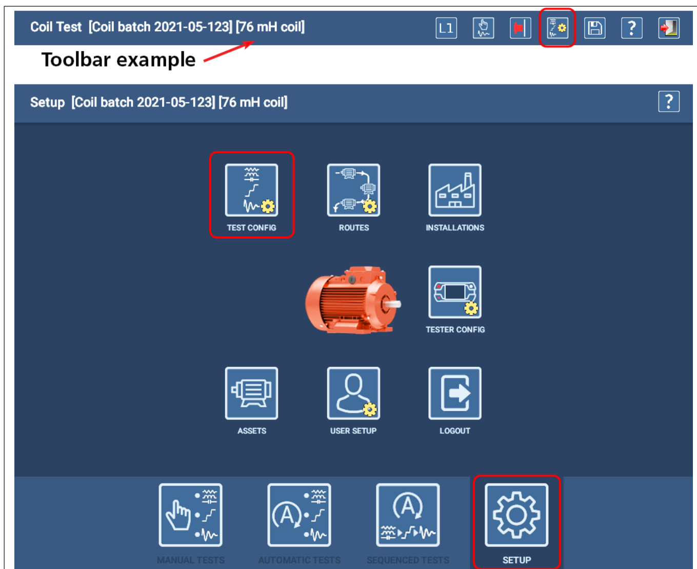
Obr. 40: Přístup k editoru konfigurace testů je možný z hlavní obrazovky nastavení nebo z ikony v horní části mnoha obrazovek testů.
