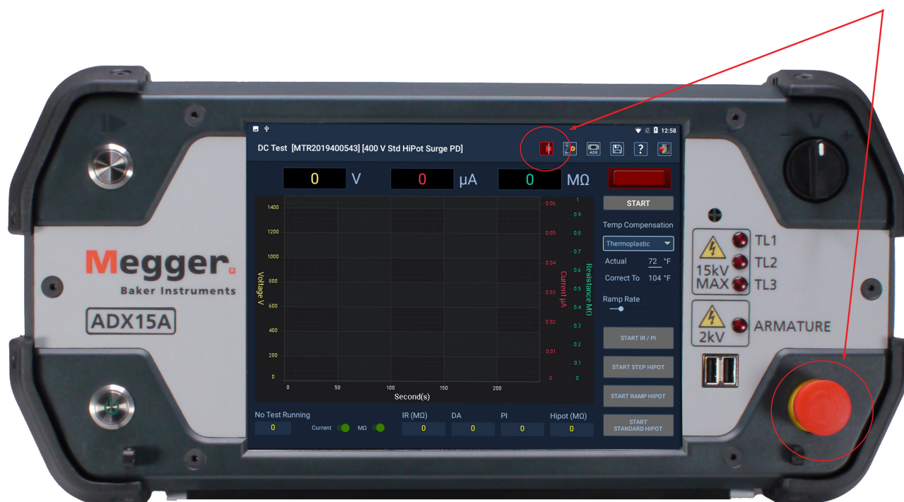
Obr. 2: Megger Baker ADX s tlačítkem zastavení zařízení.
