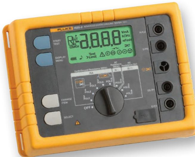
okolo zemnicí tyče a oboje jsou připojeny k testéromu. Nepoužívají se žádné zemnicí kolíky. Do jedných kleští je zavedeno pevné napětí a proud se měří pomocí druhých kleští. Tester automaticky určuje odpor zemnicí tyče.
